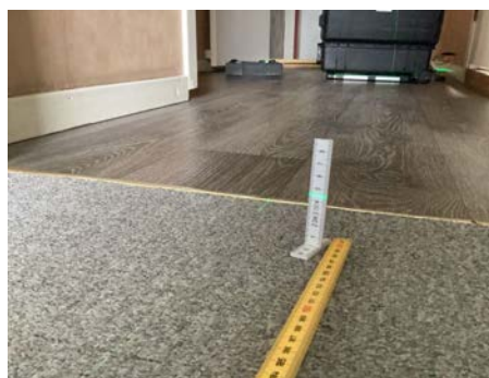
16 mm på 2 meter i stue mot gang
