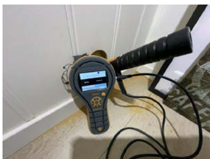
Hulltaking - Fuktmåling - Tørr konstruksjon i hulltakingsområdet.
