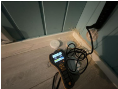
Mindre forhøyninger av fukt er målt ved hulltaking.
