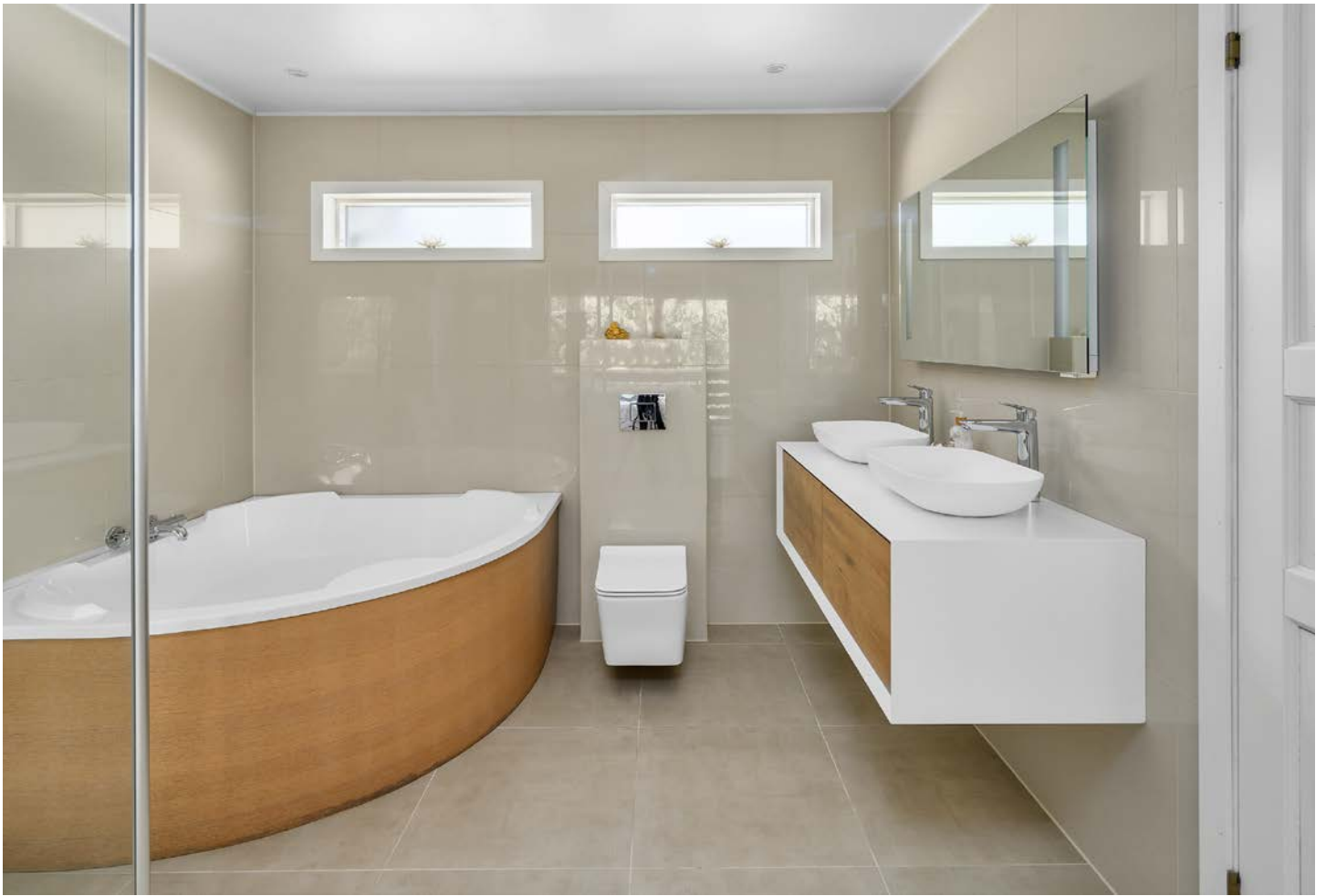
Badet er renoverert i 2020 og har flislagte flater samt varmekabler i gulv.
