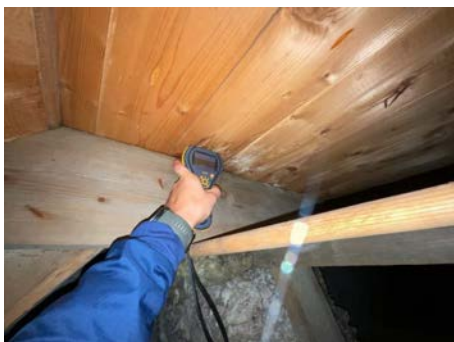
Ingen fuktavvik i undertak rundt pipe.
