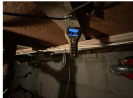
Det er målt økt luftfuktighet i krepkjeller.
