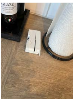
Kontroller for komfyrvakt har skade.
