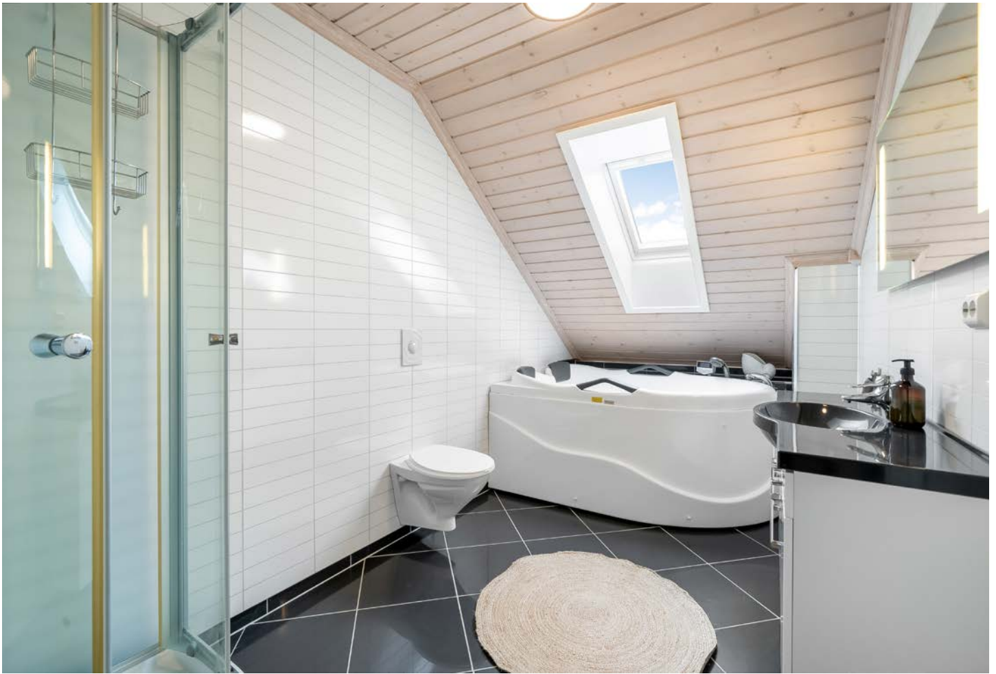
Stort bad i 2. etasje med fliser med varmekabler på gulv og baderomsplater på vegg. Rommet er innredet med baderomsinnredning, toalett, dusjkabinett og boblebad.
