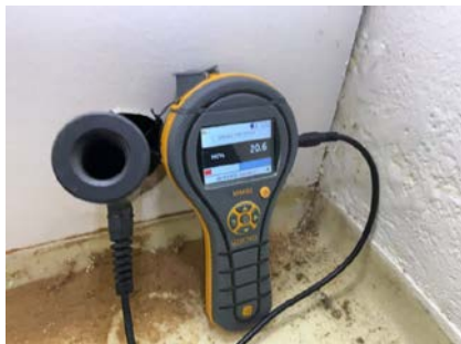
Hulltaking - Fuktmåling - Noe høyt trefuktninnhold i bunn av delevegg mellom bad og vaskerom.
