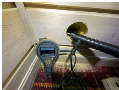
Hulltaking - Fuktmåling - Skadelig høyt trefukttinnhold i den innforede konstruksjonen.
