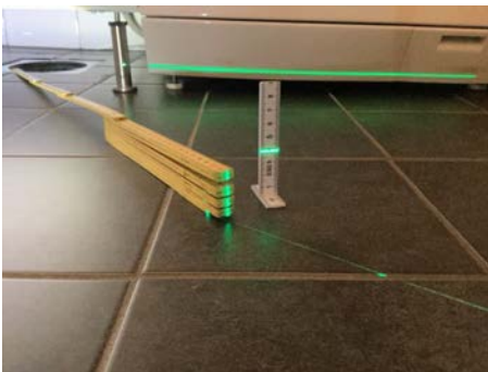
måling 80 cm fra sluk under innredning
