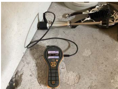
Måling med hammerelektrode / pigg i svill
