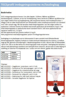
Dokumentasjon på sealingbag.
