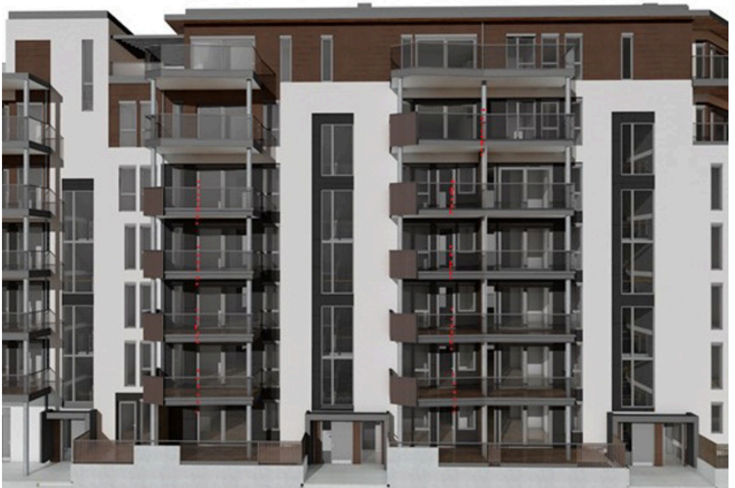
Illustrasjon bygg E som viser utvidet glass rekkverk. Dette for å oppnå bedre utsikt, og rød stiplet linjer viser opprinnelig lengde på glass rekkverk.
