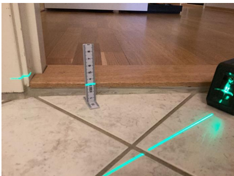
Måling ved terskel
