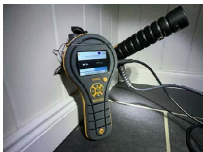
Hulltaking - Fuktmåling - Tørr konstruksjon i hulltakingsområdet.
