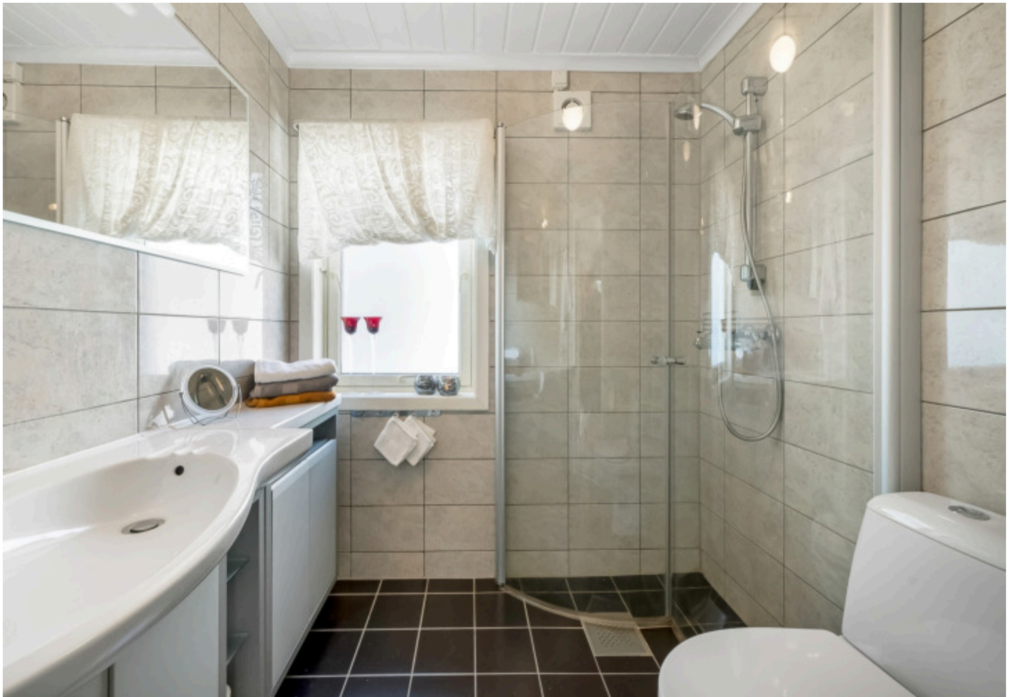
Flislagt bad med varmekabler i gulvet i 1. etasje.
