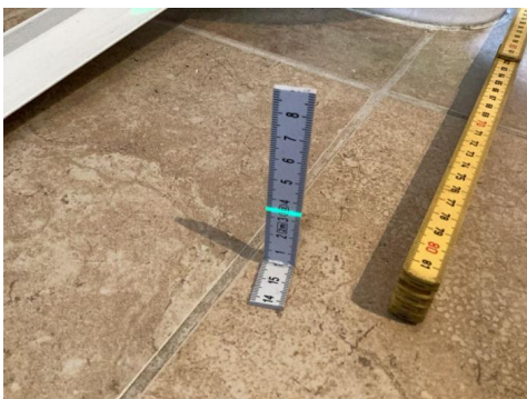
Måling 80 cm fra sluk
