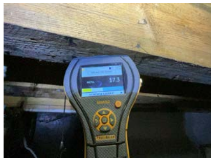
Noe høyt trefuktinnhold / vektprosent i skillekonstruksjonen mot kjellerrommene.
