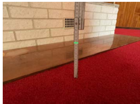
Utkastrek på laser er 11 cm på målestokk. Bilde viser ca. 30 mm høydeforskjell innefor 2 meter i peisestue.
