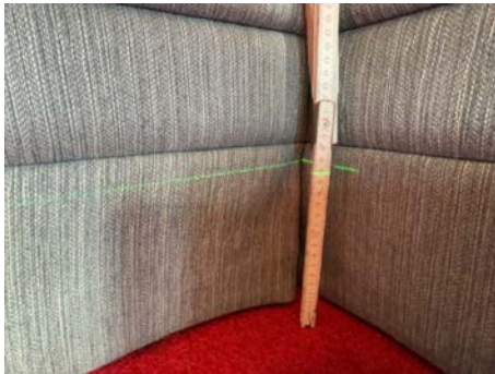
Utkastrek på laser er 11 cm på målestokk. Bilde viser ca. 50 mm høydeforskjell i rommet i peisestue.
